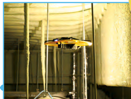
▼わずかな水位調整で 飛行可能 (気相部高さ700~800mm)
